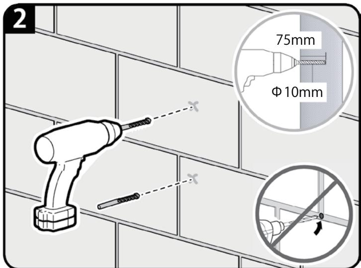
2. マーキングした位置に下穴を開けます。下穴は、10mm 径のドリルビットを使って約 75mm の深さに2箇所開けます。
