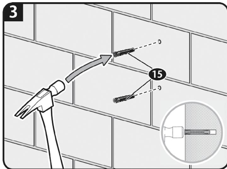
3. 2.で開けた下穴にコンクリートアンカー [15] を挿入します。
