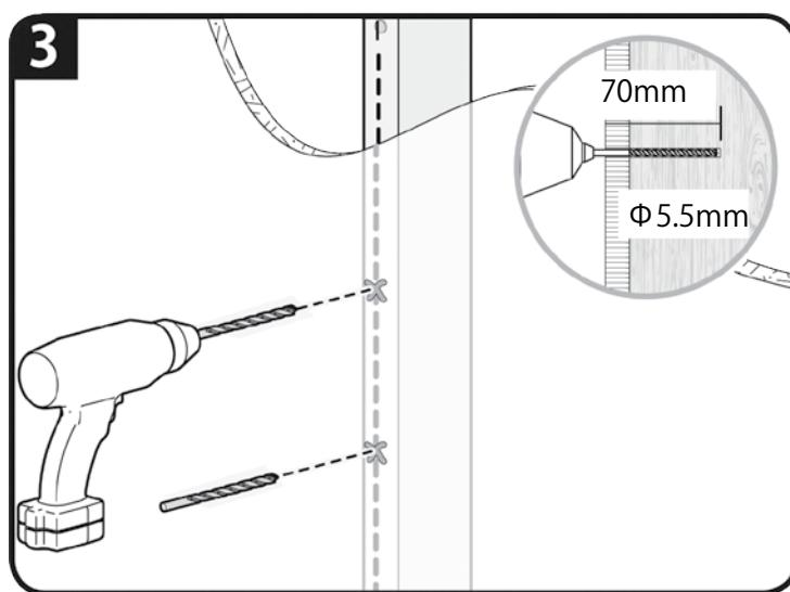
3. 2.で付けたマーキングの位置に下穴を開けます。下穴は、5mm 径のドリルビットを使って約 70mm の深さに 2 か所開けます。
