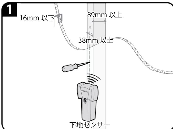
1. 下地センサーや、千枚通しや、細い釘などを使って、下図の様に柱の位置を確認します。下地センサーを左右に動かすと、柱の端を検知するので、マーキングします。二つのマーキング（両端）から柱の中心位置にマーキングを付けます。
