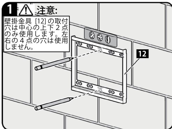
1. 壁掛金具 [12] を、図のようにご希望の高さに置き、市販の水準器で水平度を確認し、2箇所の下穴を開ける位置にマーキングをします。
