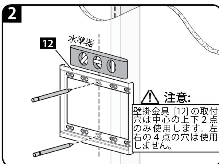
2. 壁掛け金具 [12] を、図のようにご希望の高さに置き、取付穴の位置を柱の中心線上になるよう仮配置します。壁掛け金具 [12] を市販の水準器で水平度を確認し、2箇所の下穴を空ける位置にマーキングをします。
