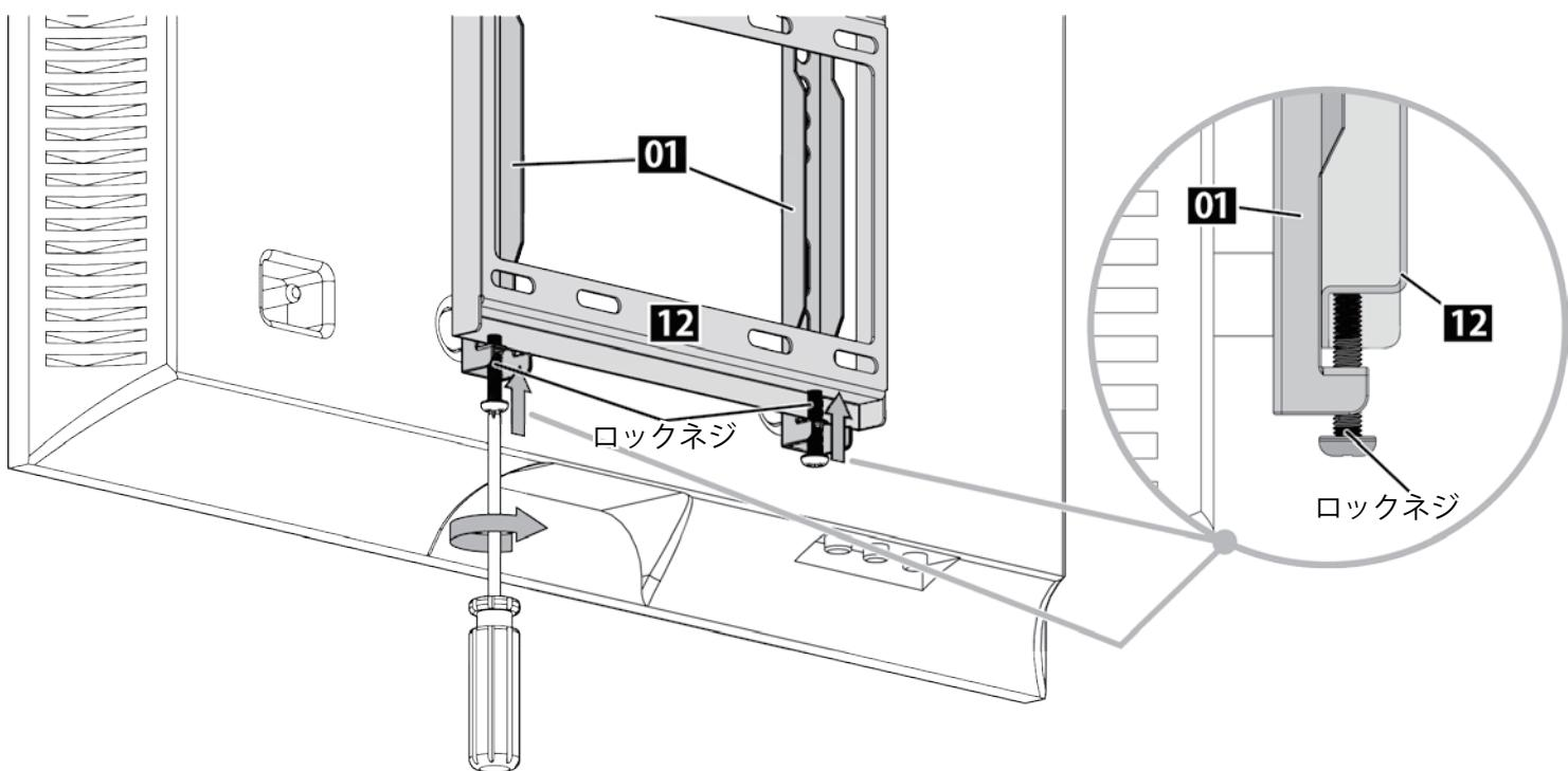
2. 次にテレビの下側を図のように壁掛け金具[12]に押あててロックネジを締め付けます。
