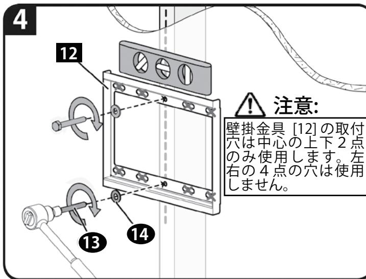
4. 壁掛け金具 [12] を下穴に合わせて柱に配置し、水準器で水平を確認しながらラグボルト [13] とラグボルトワッシャー [14] で固定します。
